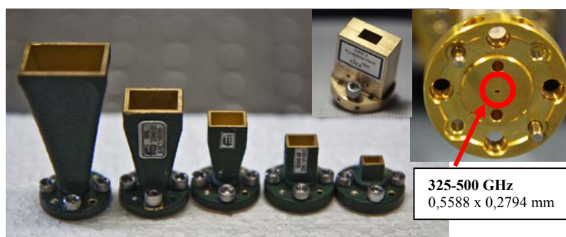
Obr. 2 Ukázka použitých vyzářovacích elementů, pásmo 50-500 GHz
