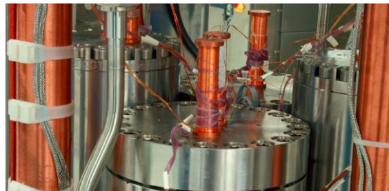
Obr. 8 Akustický plynový teploměr (vlevo) a dielektrický plynový teploměr (vpravo), obojí PTB Německo.
